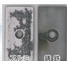
(図②) 劣化したクーラントにクーラントリカバリー添加後の試験結果
